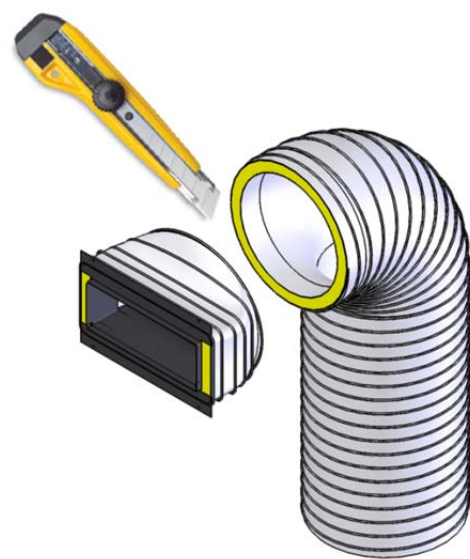
Figure 5 Préparation du conduit flexible isolé
